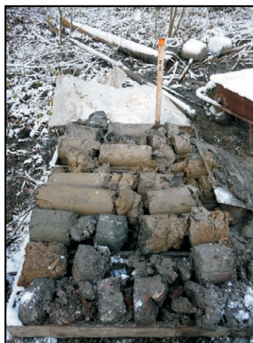
Vrtné jádro vrtu HG-1A se zastiženou vrstvou antropogenní navážky
